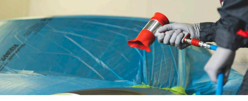
Oggi le vernici a base d'acqua sono ampiamente utilizzate nelle operazioni di verniciatura. Hanno tempi di aerazione più lunghi rispetto ai sistemi di verniciatura a base di solventi. Il conseguente maggiore tempo di occupazione delle cabine di verniciatura porta a una diminuzione della produttività dell'operazione. Con la pistola di soffiaggio a secco SATA dry jet 2 si possono ridurre notevolmente i tempi di aerazione e di occupazione della cabina.
