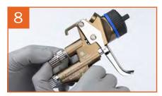
Montare la vite di regolazione del materiale
