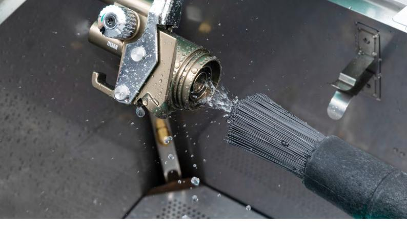
Le pistole di verniciatura si dovrebbero pulire accuratamente almeno una volta al giorno e sciacquare dopo ogni verniciatura. Ciò avviene in modo sicuro, comodo ed economico con la SATA multi clean 2 – potente dispositivo di lavaggio automatico con area di lavaggio mani e aspiratore.
