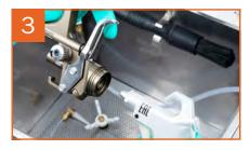
Asciugatura utilizzando la pistola di soffiaggio
