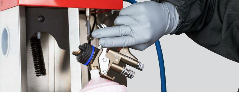
SATA clean RCS è un sistema ad aria compressa per la pulizia intermedia delle pistole di verniciatura. SATA clean RCS – the turbo cleaner nella cabina di verniciatura permette di cambiare la vernice più volte consecutivamente, con brevissime interruzioni del lavoro di pulizia. Questo non solo fa risparmiare nei tempi e nella durata del lavoro, ma aumenta anche la produttività e l'economicità.
