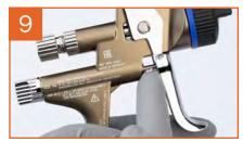
Lubrificare la parte visibile del pistone dell'aria
