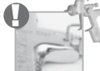
**Attention: Pendant que le pistolet est branché au circuit d'air, ne jamais démonter la vis de serrage pour le micromètre d'air, pos. 3624. Quand la vis de serrage a été démontée, ne pas mettre en service le pistolet.**
