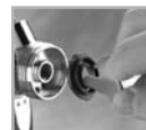
**! Assurer svp qu'aucune souillure ne s'est déposée aux bords d'étanchéité et aucune rayure n'empêche l'étanchéité optimale !**
